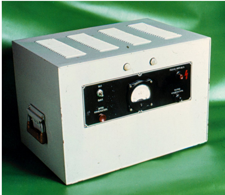
Рис. 7. Четвёртая модификация дефибриллятора ИД-1-ВЭИ, выпускавшаяся на Львовском заводе медицинского оборудования под названием ИД-1
