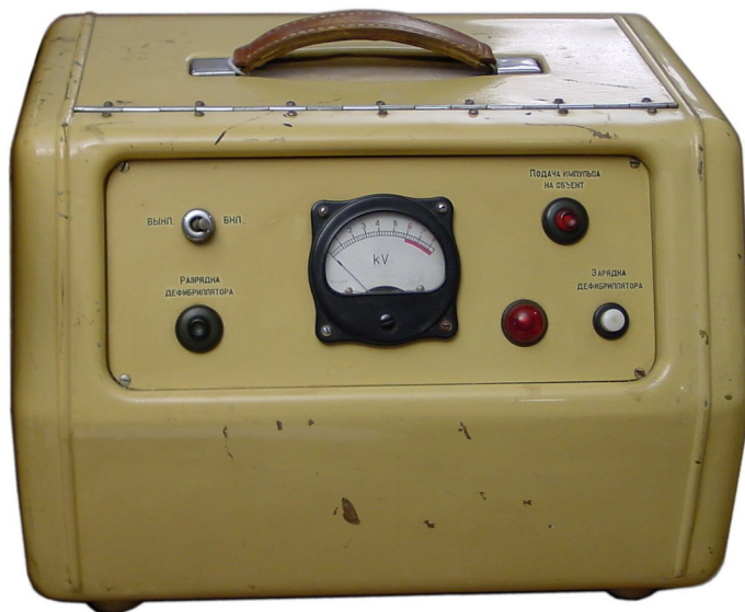
Рис. 5. Вторая модификация дефибриллятора ИД-1-ВЭИ, выпускавшаяся на опытном электромеханическом заводе Всесоюзного электротехнического института им. Ленина
