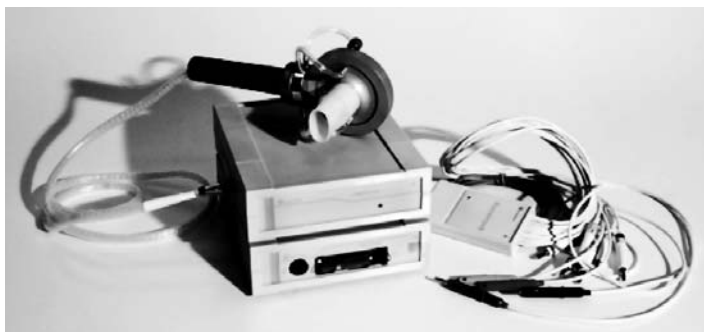
Рис. 4.6. Компьютерный комплекс КМ-АР-01 «Диамант-РМКС» для исследования кардиореспираторной системы и гидратации тканей организма человека
